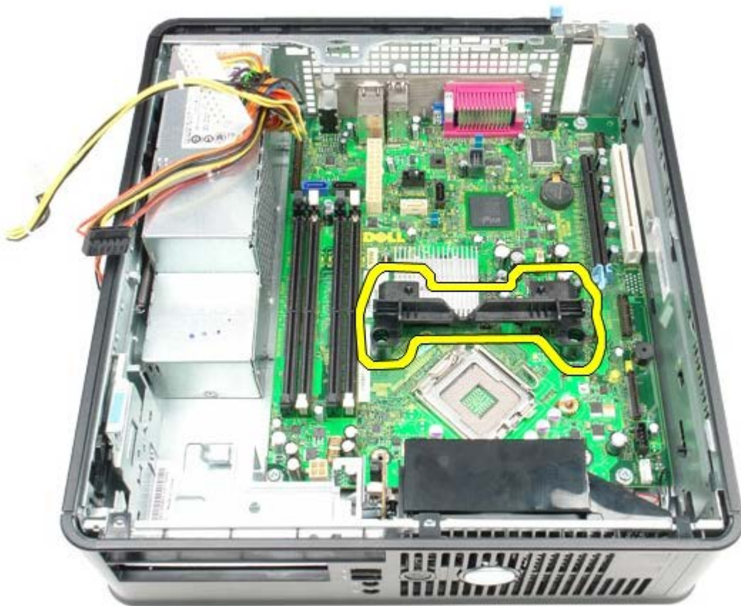
1 1 11 시스템 보드를 컴퓨터 케이스에 고정시키는 나사를 분리하십시오.
