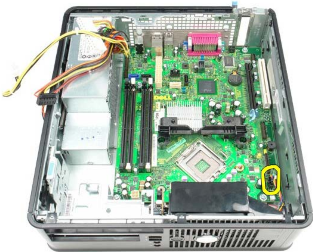
1 1 11 방열판 고정 모듈을 시스템 보드에 고정시키는 나사를 분리하십시오.
