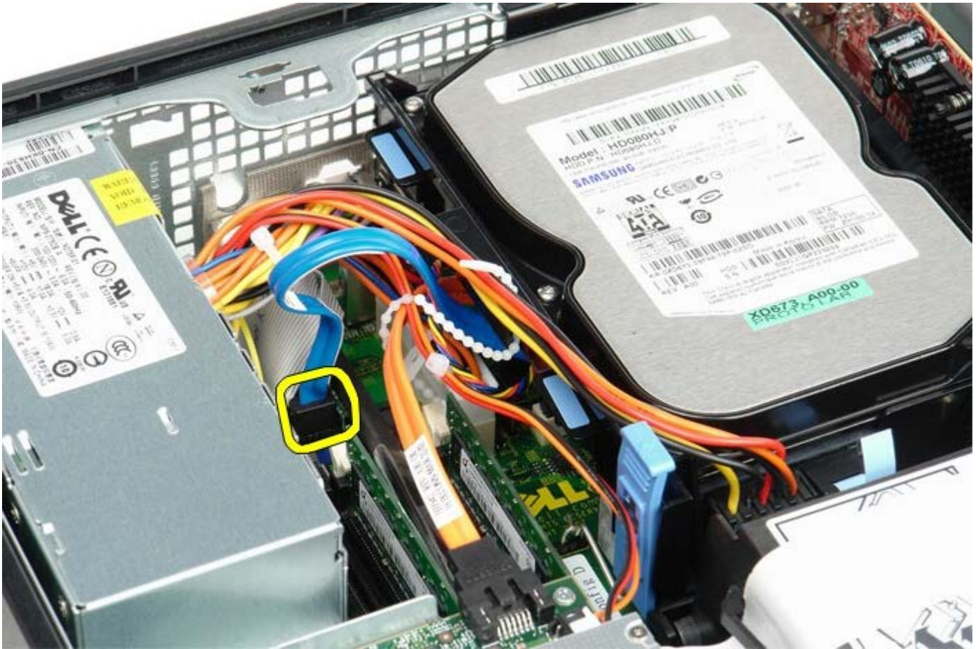
1 11 드라이브 새시 양쪽의 청색 고정 탭을 안으로 누르고 드라이브를 위로 밀면서 컴퓨터에서 빼냅니다.
